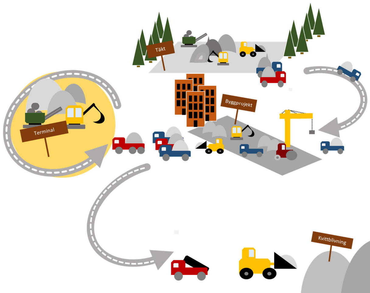
Figur 7-3. Optimass har identifierat behovet av en terminal för samordning mellan projekt för att öka återbruket av massor. På terminalen kan massor koordineras, lagras och uppgraderas tills massorna behövs i ett annat byggprojekt.
